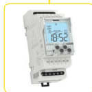
TER-9 2 teplotní vstupy, 2 výstupy 8 A přepínací, 6 funkcí, vestavěné spínací hodiny, podsvětlený LCD, galvanicky odd. napájení AC 230 V nebo AC/DC 24 V, 2 MODUL. Teplotní rozsah: -40 °C až +110 °C. Str.: 108
