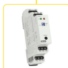
TER-7 Kontrola oteplení vinutí motoru v pásmu daném odporem zabudovaného PTC termistoru (1.8-3.3 kΩ), doplňující funkce (paměť, reset), výstupní kontakt 2x 8 A přep., napájení: AC/DC 24-240 V. Str.: 110
