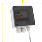
TEV-2 Termostat pro regulaci vytápění (chlazení), nastavitelný rozsah -20..+20 °C, externí senzor NTC, výstupní kontakt 16 A přep. Str.: 115
