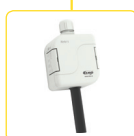
RHV-1 Hygrostat pro hlídání a regulaci vlhkosti. Rozsah relativní vlhkosti 0.. 90 % RH. Str.: 117
