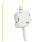
TEV-4 Jednoduchý termostat pro hlídání a regulaci teploty ve venkovních prostorech a náročných prostředích. teplotní rozsah: -30 °C až +60 °C. Str.: 116
