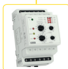
TER-4 Široký a přesný rozsah nastavení -40.. +110 °C v 10-ti rozsazích v jednom přístroji, jemné dostavení teploty, 2 vstupy pro NTC senzor, 2 výstupy 16 A přepínací, doplňující funkce (paměť, hysterese, indikace vadného senzoru) napájení: AC 230 V nebo AC/DC 24 V (galv. oddělené). Str.: 106
