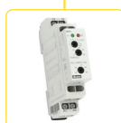
RHT-1 Hygrotermostat pro hlídání a regulaci teploty rozsah 0.. +60 °C a relativní vlhkosti rozsah 50.. 90 %. Str.: 118
