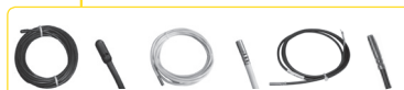
TC, TZ, Pt100 Externí teplotní senzory pro termostaty v délkách 3 m, 6 m, 12 m - TC/TZ: termistor NTC 12 kΩ / 25 °C - Pt: článek Pt100 (pouze TER-3G). Str.: 119
