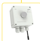
TEV-3 Termostat pro regulaci vytápění (chlazení), nastavitelný rozsah 5.. +35 °C, externí senzor NTC, výstupní kontakt 16 A, ovládací potenciometr a indikace na panelu. Str.: 115
