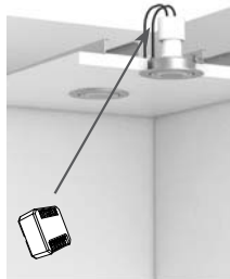
montáž do podhledu
